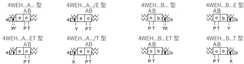
液压复位阀 (由三位阀派生的二位阀电磁铁在A端或B端)
